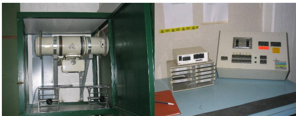
Figura 4.1 – Espositore a raggi X e postazione di controllo.
