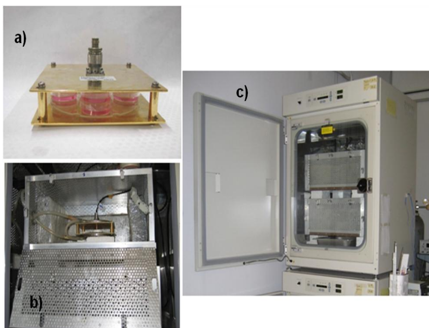
Figura 4.2 - WPC che alloggia quattro capsule di Petri (a); griglia metallica che schermata la WPC (b); sistema di esposizione alloggiato in un incubatore per colture cellulari (c).
