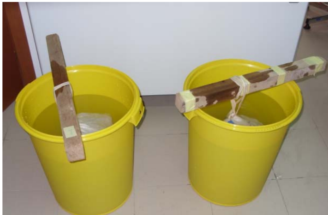
Figura 6.6 - Particolare della prova per determinare la capacità assorbente
