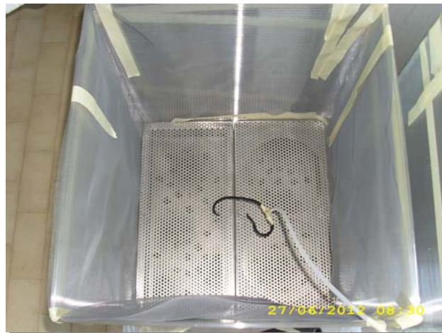
Figura 6.21 - Veduta dell'interno del reattore di biostabilizzazione.
