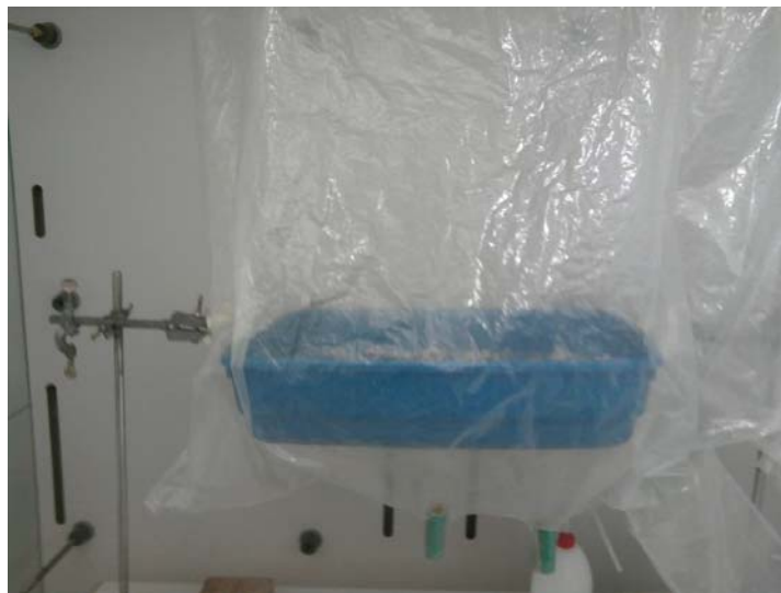
Figura 6.7 Sistema sperimentale per la determinazione del rilascio di ammoniaca
