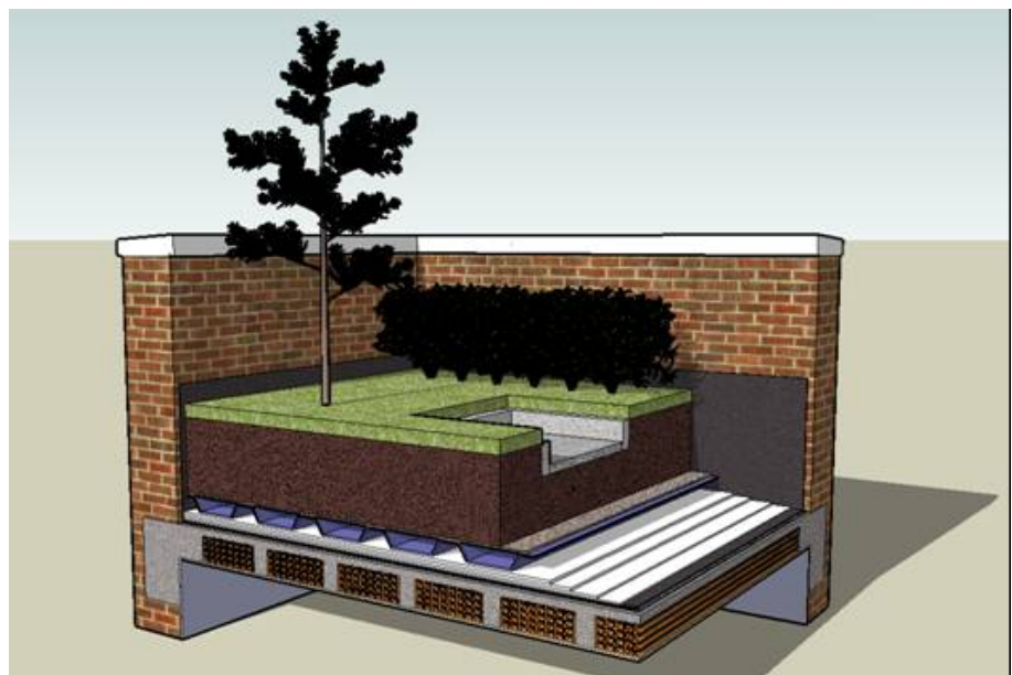
Figura 4.8 Tetto verde a tipologia intensiva
