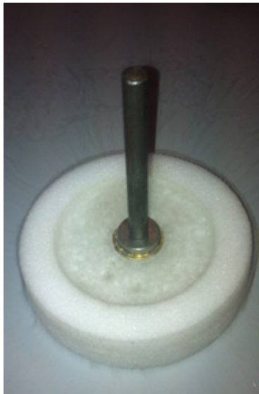
Figura 5.5: Mantenendo in sospensione si crea un link magnetico
