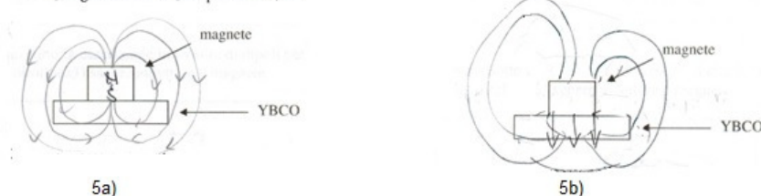
Figura 8.2 Un magnete poggiato su un disco YBCO a temperatura ambiente: Esempi di linee di campo.
