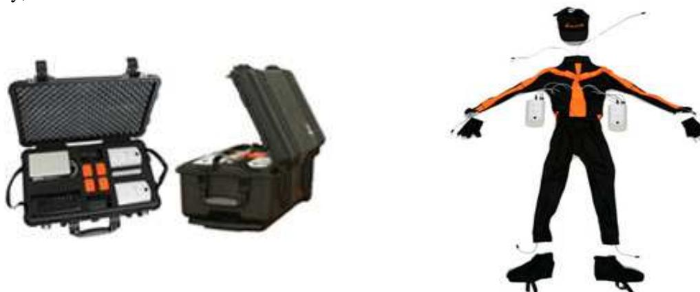
I sensori inerziali forniscono dati assoluti di orientamento, che possono essere utilizzati anche per calcolare le accelerazioni 3D in coordinate assolute, dalle quali ricavare stime dei movimenti di traslazione a cui sono soggetti i segmenti corporei. Il sistema Moven si basa su un modello biomeccanico di 23 segmenti, in modo da
