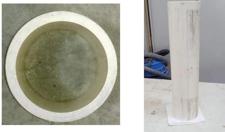
Figura 5.20. Profilo tubolare di GFRP.
