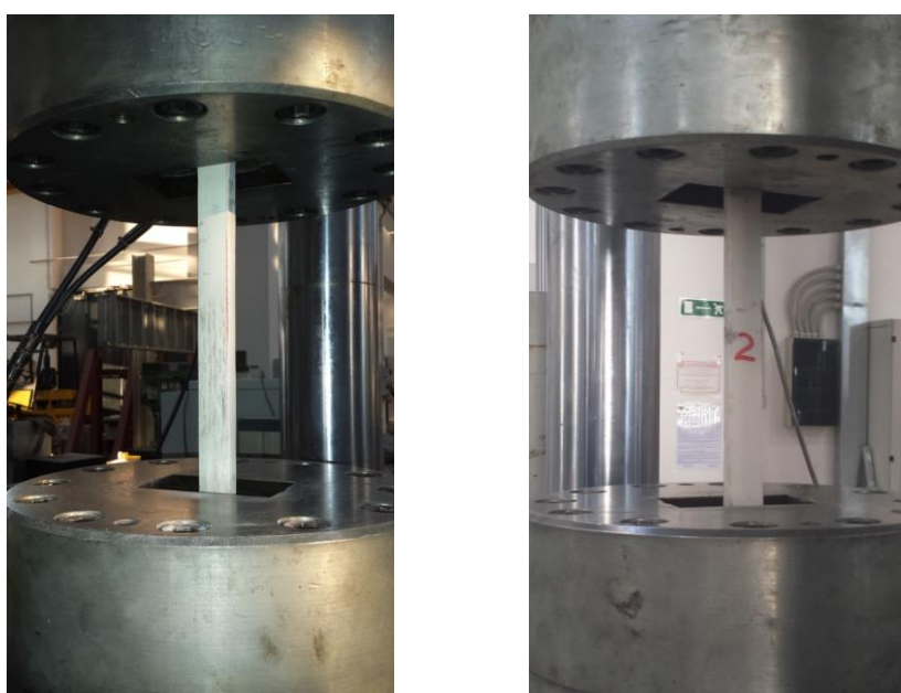
Figura 5.2. Test preliminare su GFRP, campione “1” e “2”.
