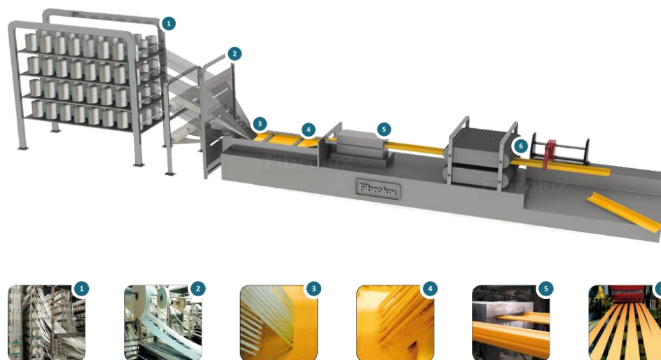
Figura 1.1. Processo di pultrusione.
