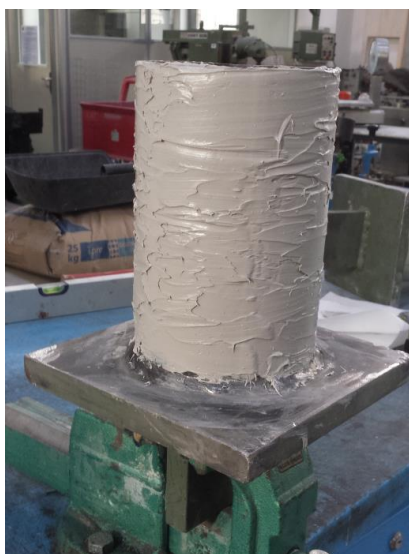
Figura 5.22. Applicazione della resina lungo la parete circonferenziale del profilo metallico.
