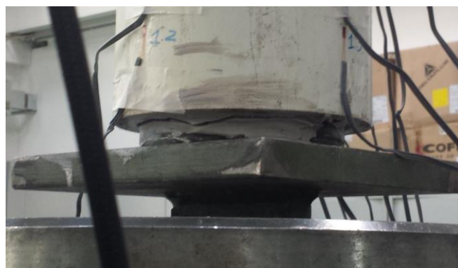
Figura 5.28. Crisi dell'interfaccia coesiva.
